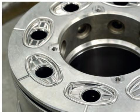
■ Blick in die Werkzeug-Endmontage bei Ruhla (oben). Im Vordergrund das Werkzeug für die Fertigung des 10 ml Spritzenkörpers.
