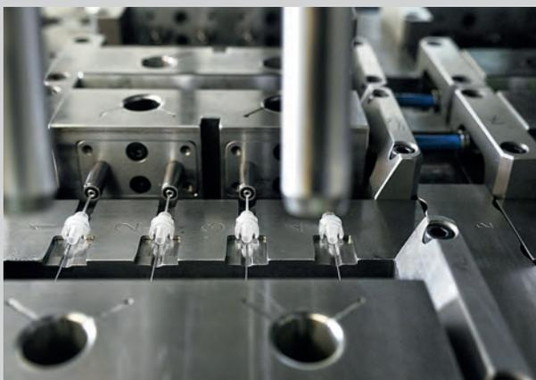
Il componente "adattatore di ventilazione" sulla parte mobile stampo con i carrelli (sopra). Sistema ad otturazione con ugelli dall'ingombro ridotto e collettore compatto, per la produzione dell'adattatore di ventilazione (destra).
