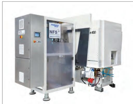
Attuazione simultanea degli otturatori con piastra sincrona (sinistra). Unità produttiva automatizzata equipaggiata con il sistema di alimentazione aghi NFS Zahoransky ed una pressa completamente elettrica Engel e-motion (destra).
