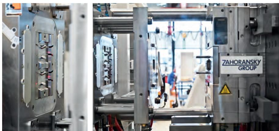
Lo stampo con piastra matrice e maschi con piastra estrazione nel lato canale caldo (sinistra). Un sistema di scansione laser è utilizzato per verificare la presenza degli aghi, durante il loro inserimento (estrema sinistra)
