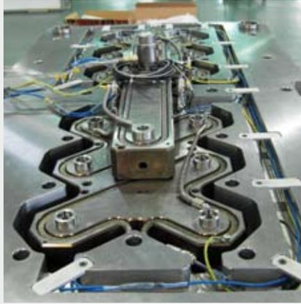
Verteilerlayout: Zwei 6-fach Verteiler werden von einem Brückenverteiler versorgt.
