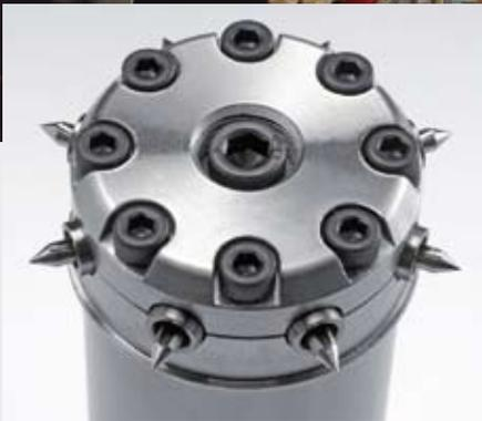
HPS III-MH Düse in 8-fach Ausführung (oben). Bauteile aus der 96-fach Heißkanalfertigung (unten) und der bisherigen Fertigung mit Teilheißkanal (ganz unten). Die Angussreste erforderten zusätzliche Peripheriegeräte.
