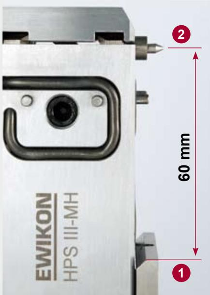
Riegel (1) fixieren die Düse im Werkzeug und begrenzen die freie Dehnlänge des Düsenkörpers. Damit ändert sich die Position der Spitzen (2) beim Aufheizen nur minimal. Dies ermöglicht runde Anschnitte und eine gute Abrissqualität (unten).
