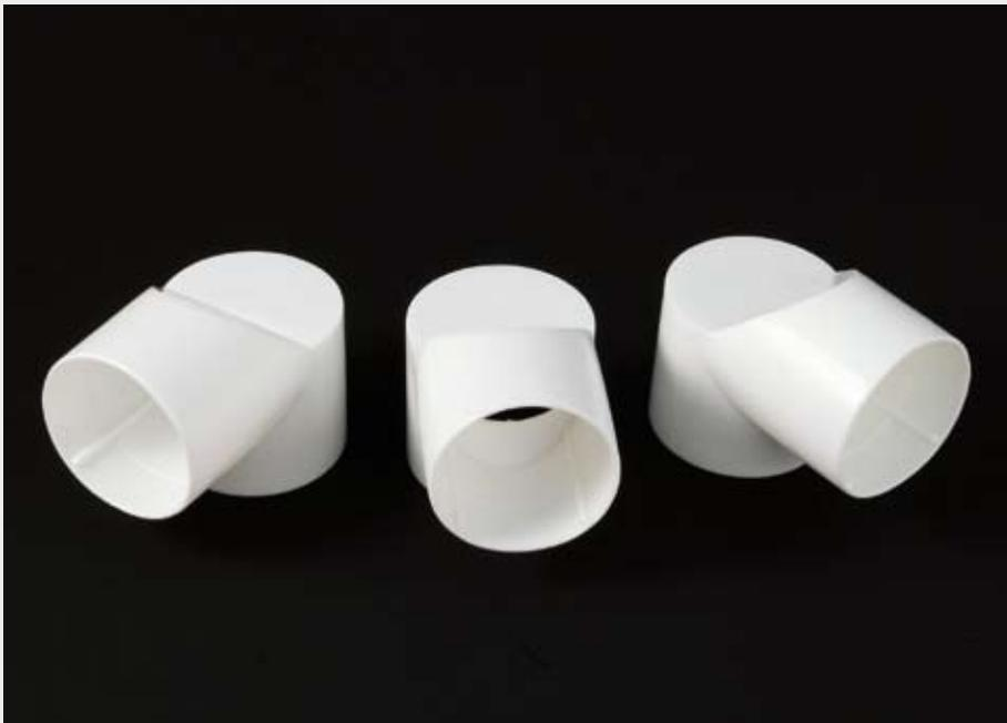
Der Sprühkopf aus HDPE besitzt eine um 90° abgewinkelte Auslassöffnung. Um entformen zu können, ist eine Schiebermechanik notwendig.
