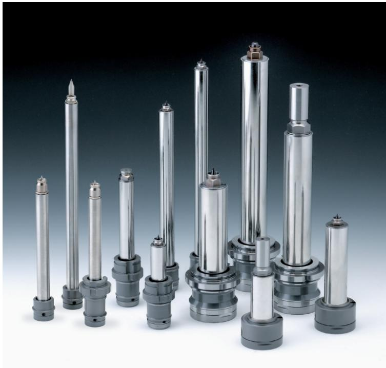
Die HPS III-S Hochleistungsdüsen mit Dichtung in Anschnittnähe sind für die Verarbeitung fast aller thermoplastischen Werkstoffe einschließlich verstärkter Materialien geeignet. Schraubbare Spitzeneinsätze bieten eine hohe Variabilität bei der Anschnittgestaltung. Die Anbindung kann je nach Anwendungsfall über Ringspalt (Spitze) oder offen erfolgen. Zusätzlich sind verschiedene Vorkammer- und Anschraubvorkammervarianten erhältlich.
