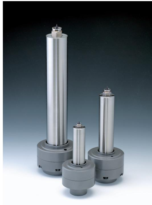
Die HPS III-SXE Einzeldüsen ermöglichen die problemlose Direktanspritzung von Artikeln in Einzelwerkzeugen. Durch den einteiligen Düsenaufbau mit mindestens zwei separaten Heizzonen und zusätzlicher keramischer Wärmeisolierung zwischen Druckrohr und Düsenkörper wird ein äußerst ausgewogenes Temperaturprofil erreicht.
