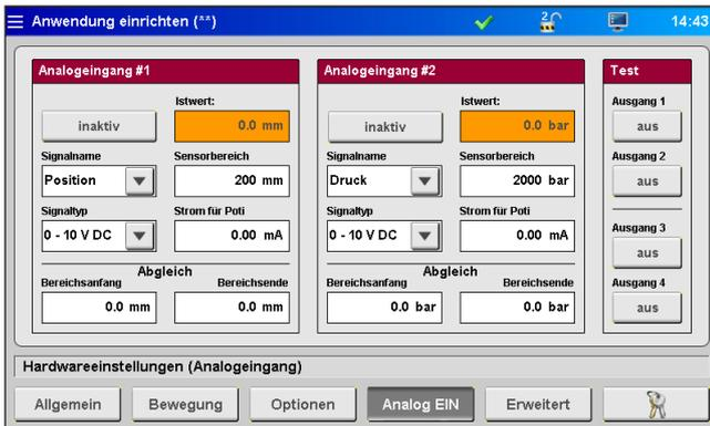
Abbildung 20: Ansicht "Hardwareeinstellungen (Analogeingang)"
