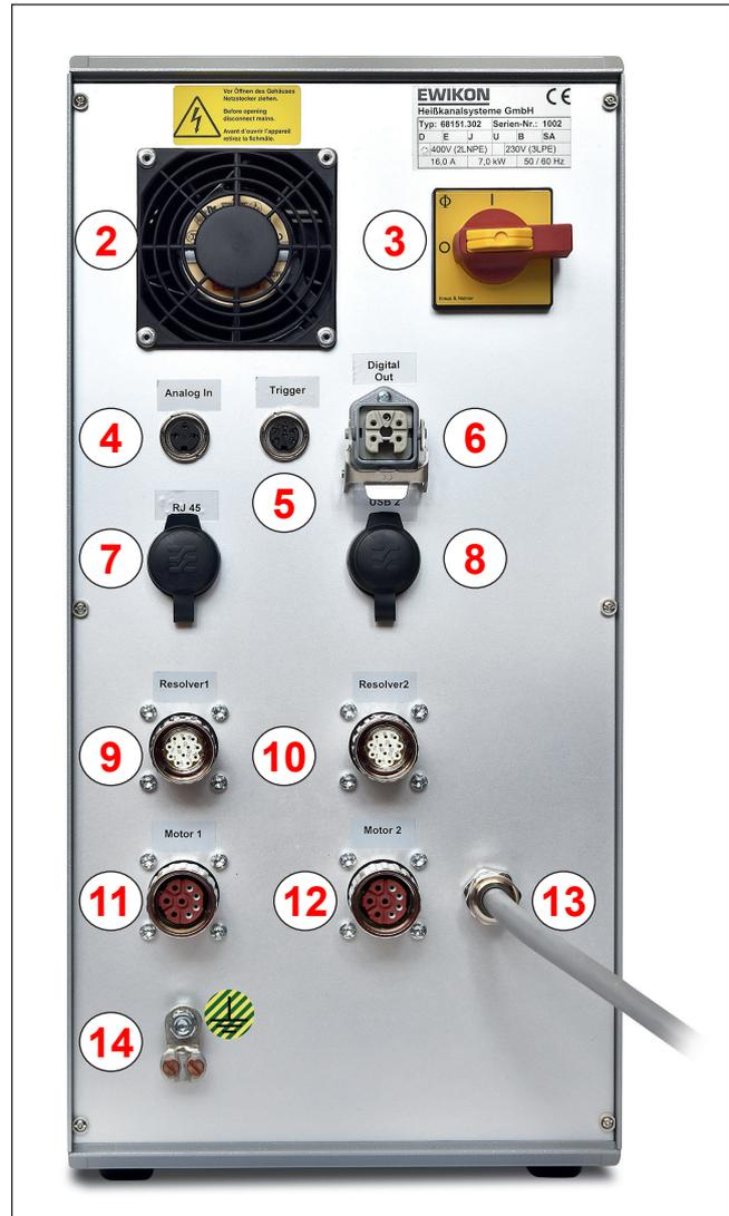
Abbildung 3: Anschlüsse an der Rückseite des SDC-PRO Steuergeräts
