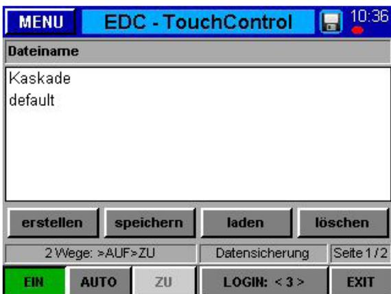
Auf Seite 1 in diesem Menü ist es möglich, die Einstellungen für bis zu 20 verschiedene Werkzeuge im Speicher des EDC-Systems, einer CFMemoryCard, zu sichern oder von dort zu laden.
