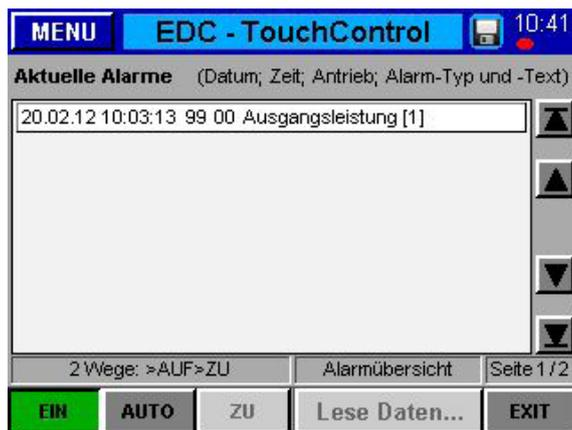
Sollte das System einen Alarm generieren, kann dieser über diesen Menüpunkt mit Datum, Uhrzeit, Antrieb, Alarmtyp und Alarmtext zur genaueren Analyse angezeigt werden.
