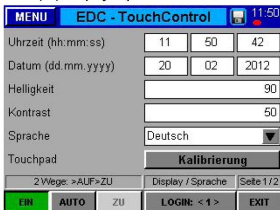
In diesem Menü werden die Einstellungen für Datum, Zeit, Helligkeit und Kontrast sowie die Spracheinstellung des Displays des EDC-TC Systems geändert. Außerdem kann eine Kalibrierung des Touch-Screens erfolgen, sollte dies notwendig sein. Es ist empfehlenswert, sich mit einem höheren Zugangslevel einzuloggen, um Werte zu ändern.
