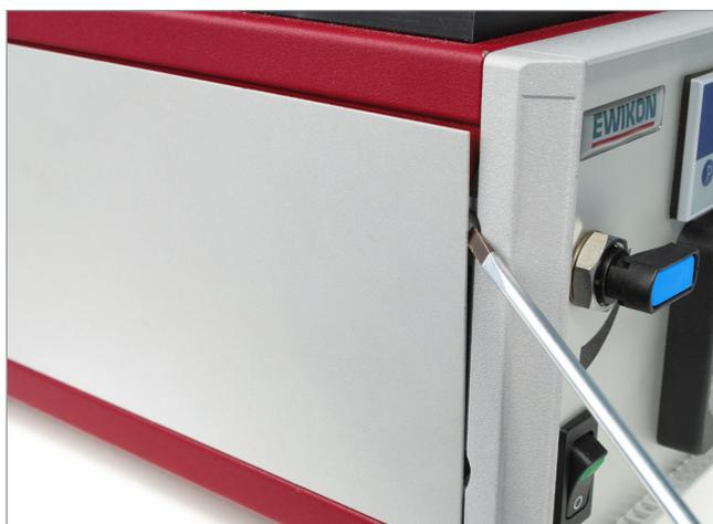
Entfernen Sie die Blende mit einem Werkzeug, wie im Bild zu sehen ist.
