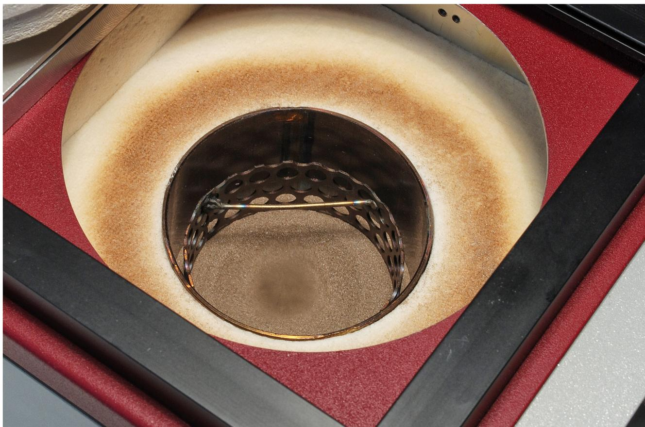
Die Reinigungskammer ist mit kalibriertem Quarzsand gefüllt, welcher durch Einblasen von Luft in Bewegung versetzt wird (suspendierte Partikel). Die Teile, die gereinigt werden müssen, können mit Hilfe des Korbes in den brodelnden Sand eingetaucht werden.
