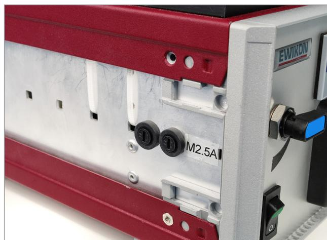
Bitte verwenden Sie beim Ersetzen der Sicherung immer eine des gleichen Typs:
