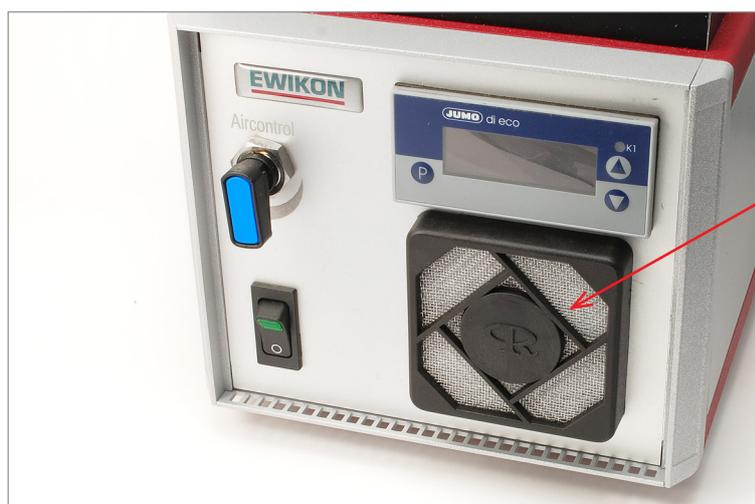
Lüftungs-Schutzgitter mit Filter nach vorne abziehen
