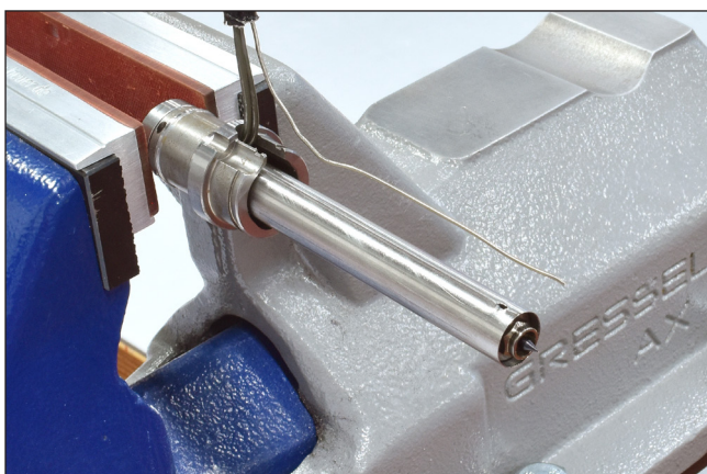
Abbildung 99: Defekten Thermofühler demontieren
