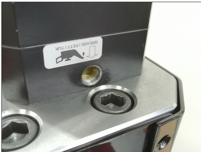
Abbildung 113: Gewindebohrung für die Schmierung des Servo-Antriebs
