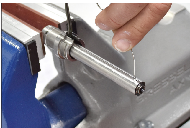
Abbildung 85: Thermofühler in die Bohrung der Düse stecken
