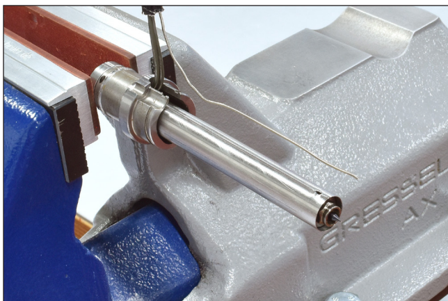
Abbildung 83: Defekten Thermofühler demontieren
